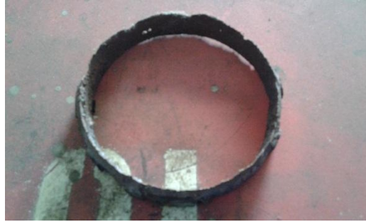
Wearing ring casing yang mengalami indikasi kerusakan
