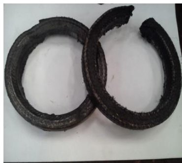
Gambar 5. kondisi packing ketika rusak.
