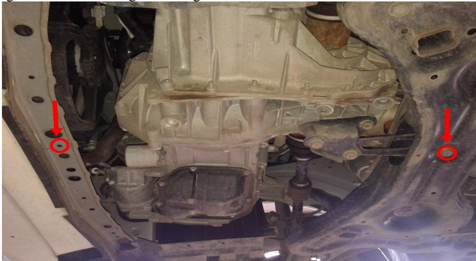
Gambar 6. Simulasi Penempatan Mur dan Baut untuk alat Engine Holder
