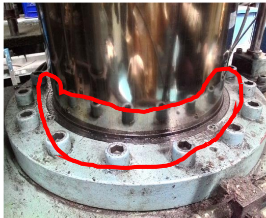
Gambar 4. Rembesan oli hidraulik pada Wiper Seal
