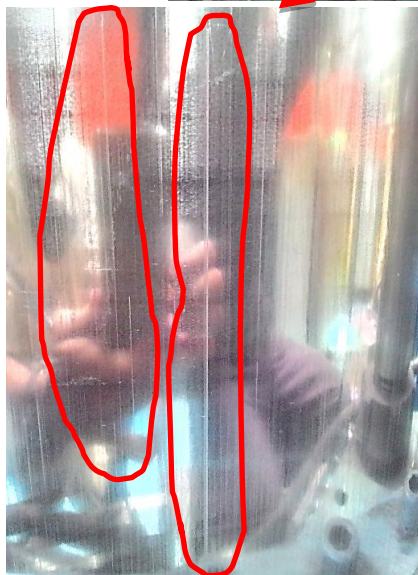
Gambar 1.Piston mesin hot press tergores
