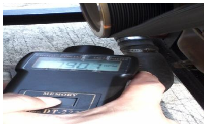
Gambar 1 Proses pengukuran rpm engine 3066 menggunakan tacho meter
