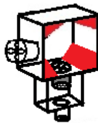
Gambar 2. Konstruksi dari filter bahan bakar
