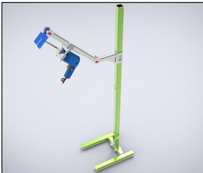
Gambar 3. Bor tangan dengan menggunakan jig and fixture
