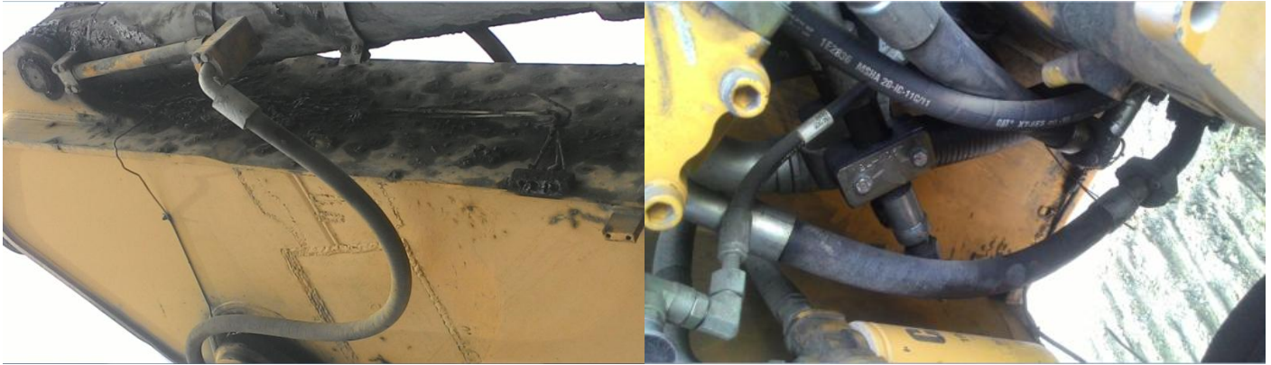
Gambar 4. Kerusakan Akibat Gesekan
