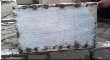
Bagian belakang boxControl panel yang sudah jadi namun belum di cat
