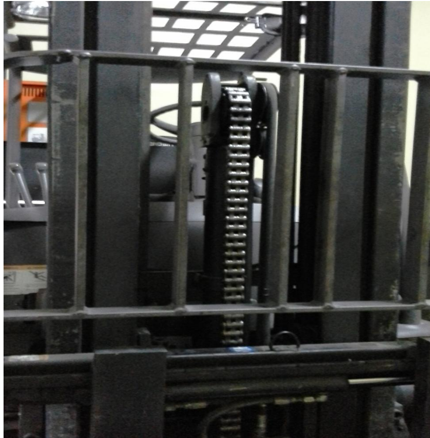
Gambar 2. lokasi leaf chain pada electric forklift crown tipe SC 5200
