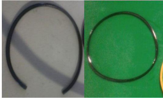
Gambar 1. Keadaan permukaan seal lama
