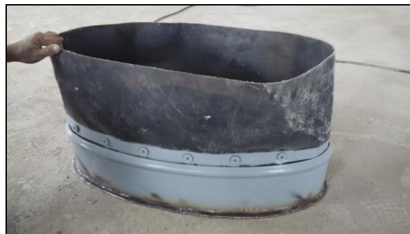
Gambar 3.5 Bentuk nyata chute inlet modifikasi
