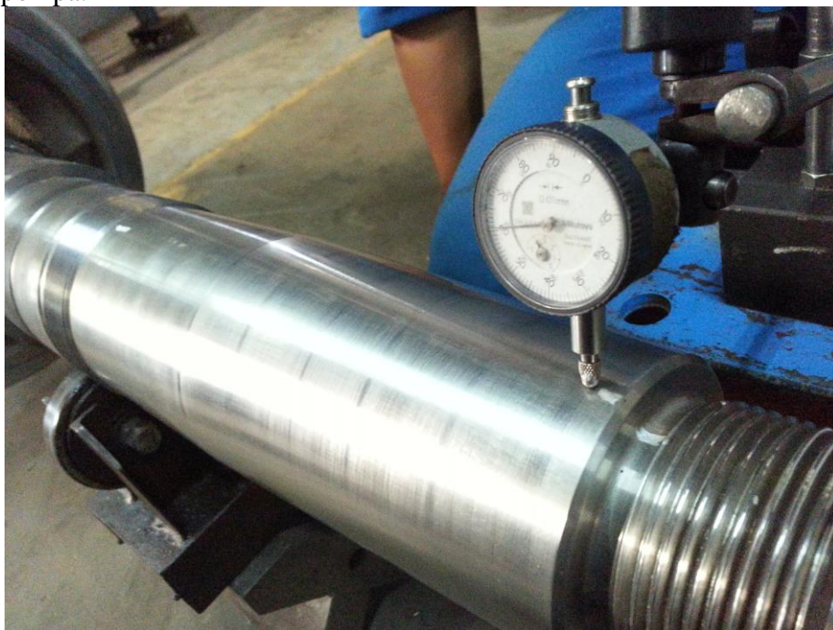
Gambar 2 Pengukuran kelurusan shaft
