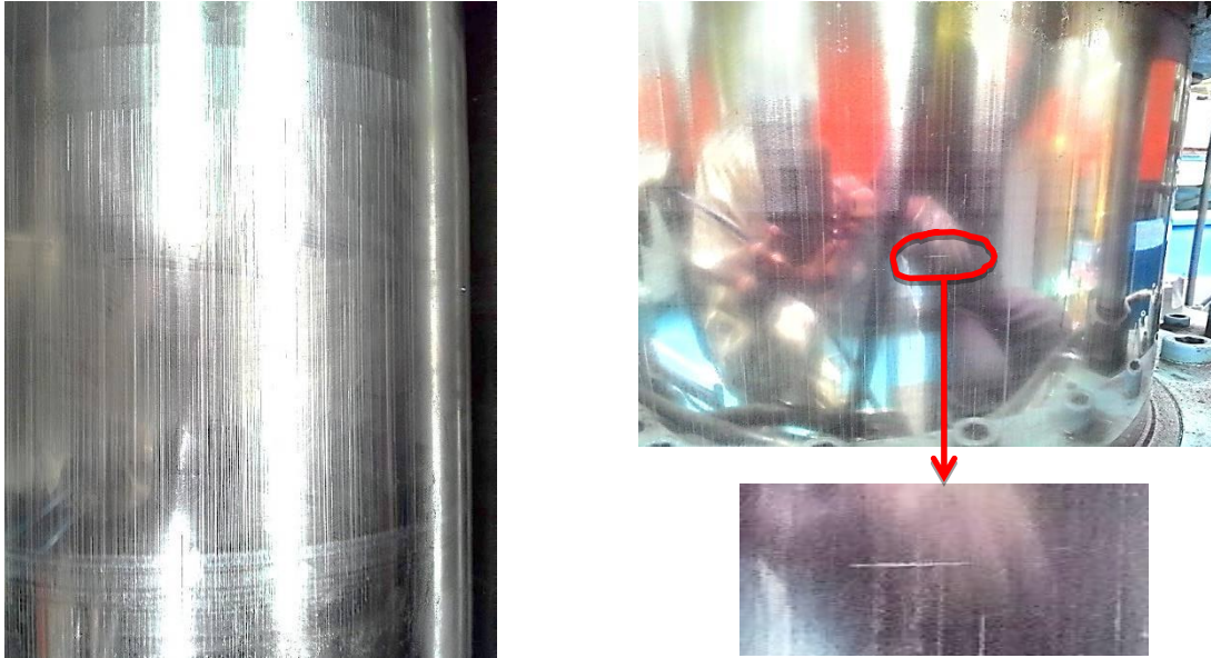
Gambar 3. Goresan horisontal pada piston mesin hot press
