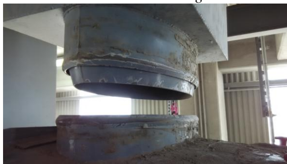
Gambar 3.1 Bentuk Chute inlet sebelum modifikasi
