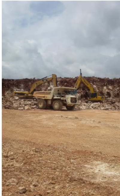
Gambar 1. Pola Muat Top Loading Backhoe 336D CAT terhadap TEREX TA400
