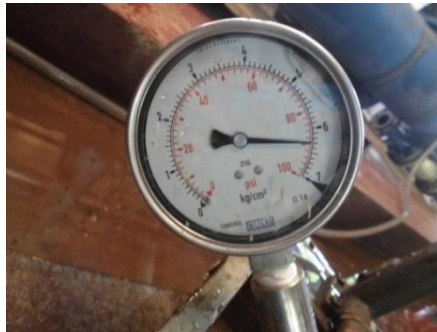
Gambar 3.24 Pemberian tekanan pada saat tes kebocoran
