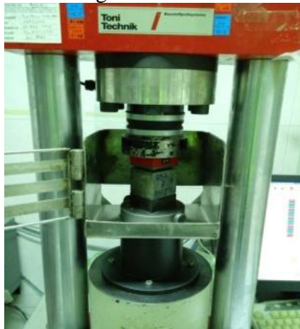
Gambar 3. Pengujian Kuat Tekan
